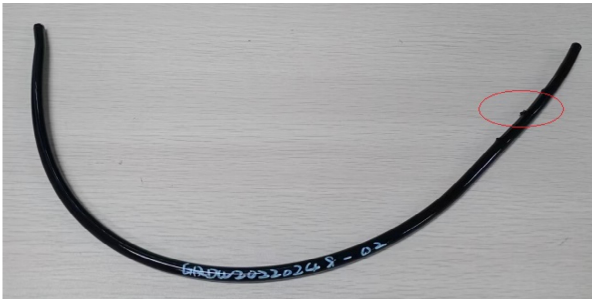
图2 GQDW20220248-02爆破压力后样品的爆破状态和位置
