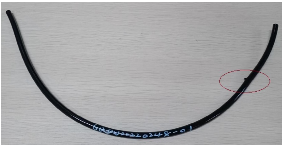
图1 GQDW20220248-01爆破压力后样品的爆破状态和位置
